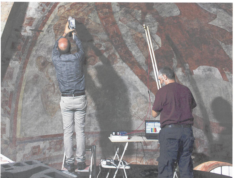
Abb. 5: Durchführung berüh- rungsfreier Messungen (XRF und FORS) zur Bestimmung der Pigmen- te der karolingischen Fresken in der Mittelap- sis, 2018. Zu sehen sind Mitarbeiter der Scuola Professionale della Sviz- zera Italiana, Lugano, und der Università del Piemonte Orientale, Alessandria.
