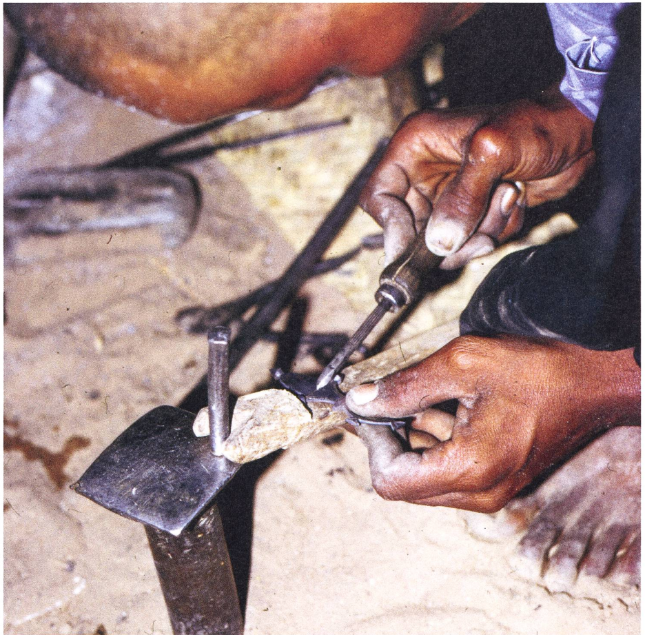
Abb. 2: Ein Silberschmied der Touareg (Agadez, Niger) ziseliert resp. graviert ein zuvor im «Wachsausschmelzverfahren» gegossenes und glatt gefeiltes Schmuckstück aus Silber.
