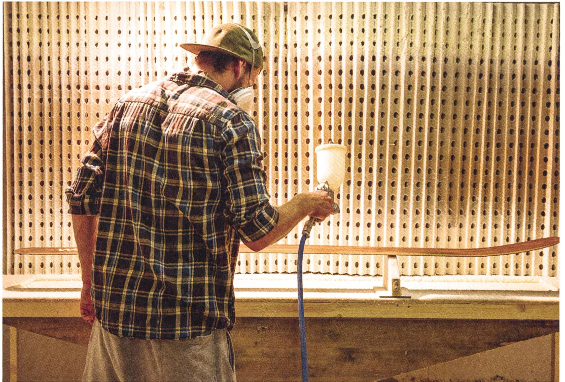
Application de la couche de finition au pistolet.
