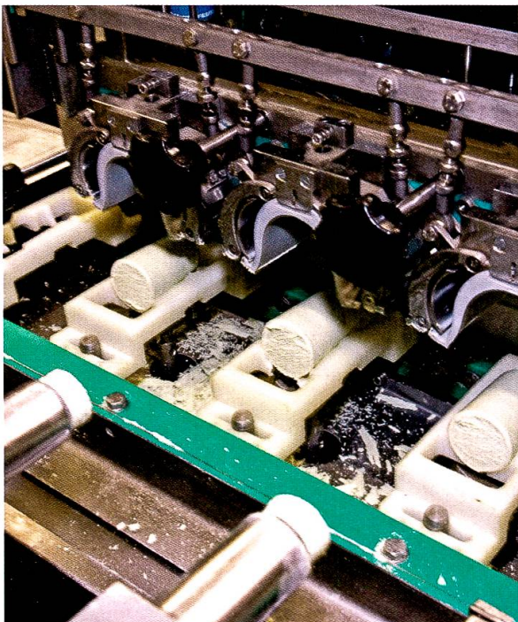
Heute formt nur diese Maschine die Zigerstöckli.
