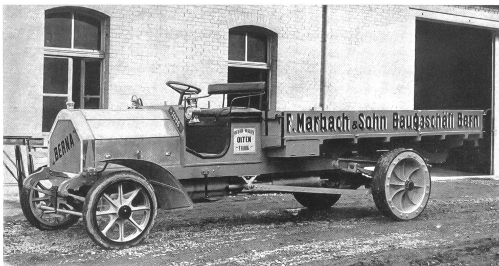
5-Tonnen-Lastwagen BERNA 40-PS-Benzinmotor
