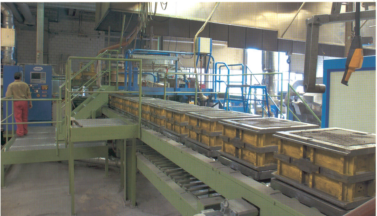
Die 1973 bezogene Giesserei in Trimbach wird seit ihrem Bau laufend dem Stand der Technik und den Erkenntnissen der Umwelttechnologie angepasst. So wird 1999 eine automatische Vergiessanlage installiert (Bild). Diese Betriebsstätte stellt heute für den Nussbaum-Eigenbedarf und für Drittkunden gegen 800 Tonnen Guss pro Jahr her und gehört damit zu den grössten Giessereien ihrer Art in der Schweiz.
