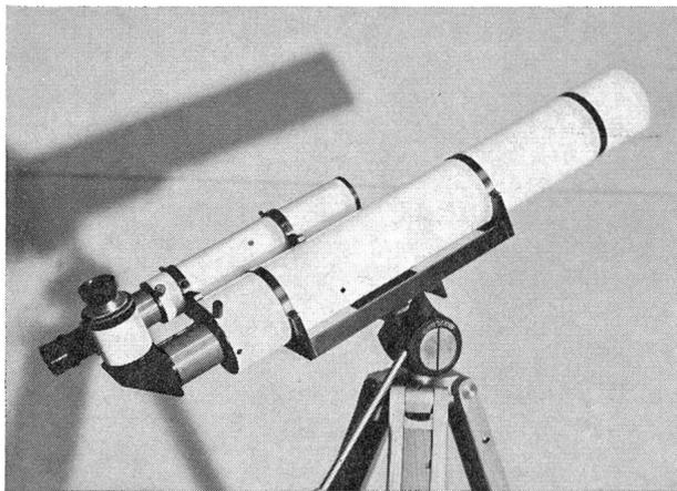
Kleines Linsenfernrohr (Vergrösserung bis 100×) auf Geometerstativ mit Kino-Stativkopf zur leichten Ausrichtung auf das Objekt. Der damit gezeigte Sucher ( $f = 30$  cm, 8 bis 20×)<sup>4</sup>) und das Zenitprisma können, ebenso wie eine einfache paralaktische Montierung<sup>4</sup>), später hinzugefügt werden.
