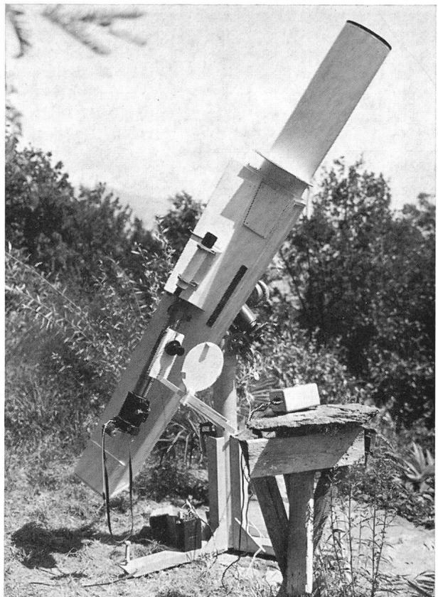
Der gefaltete Refraktor von W. BRÜCKNER, mit welchem das Titelbild dieses Heftes aufgenommen worden ist. Man erkennt die durch die Faltung des Strahlengangs bedingte Schräglage der Kamera, sowie den zusätzlichen Projektionsschirm, aber auch die stabile Montierung. Wir danken dem Autor für die Überlassung dieser Aufnahme.
