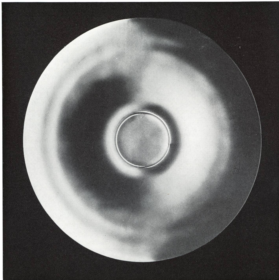
Fig. 3: Das erste FOUCAULT-Bild des 800 mm-Spiegels. Deutung dieses Bildes: siehe Text.
