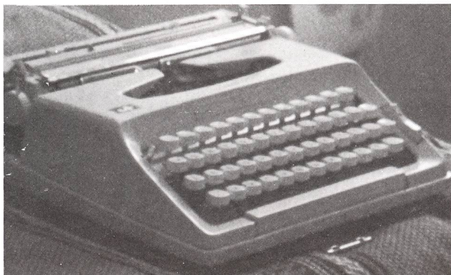
9) Dans la nuit, à l'oeil nu on ne distingue que le contour général de cette antique machine à écrire. Cette photo de l'écran fluorescent correspond à ce que l'on voit à travers l'intensificateur. La machine est visible comme en plein jour.
