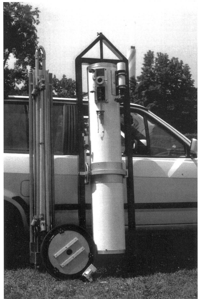
Bild 3: Demontierte Tetraedermontierung. Ersichtlich sind die im U-Profil zum Transport versorgten Rohrstützen, Rahmen mit Rohr und Antriebseinheit.
