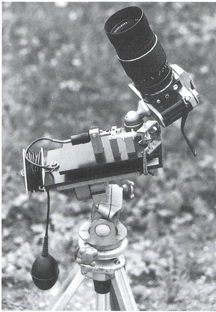
Fig. 2. Mit Luftpumpenbetrieb erschütterungsfreies Nachführen eines 200mm Teleobjektivs.
