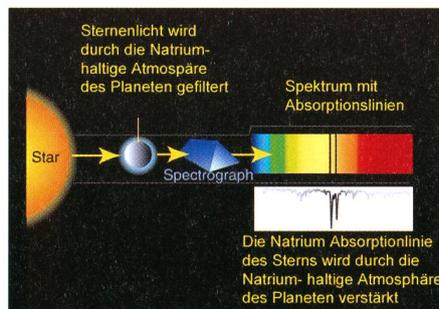
Fig. 5: Wie Spektroskopie funktioniert.
