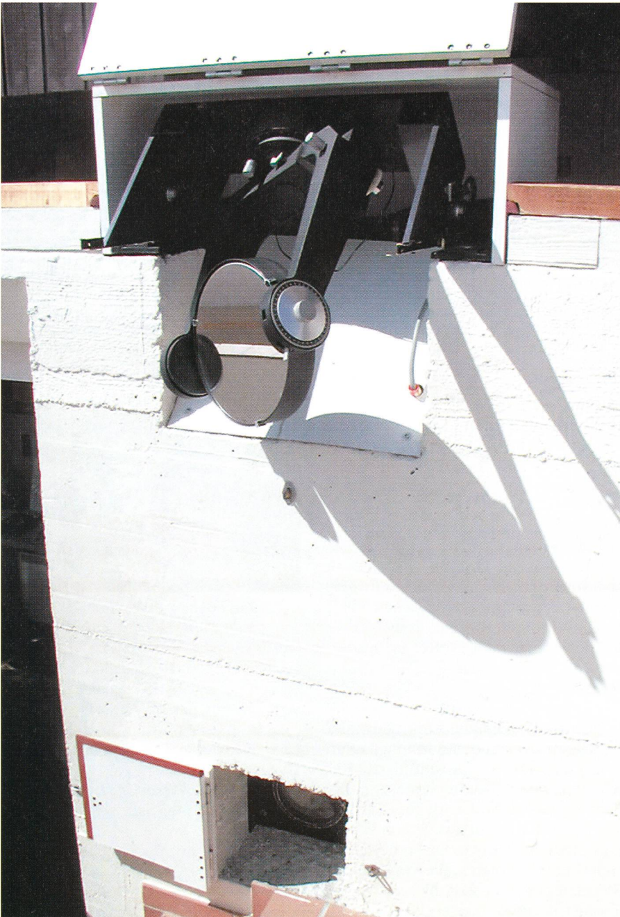
Fig. 4: Der Coelostat Typ: Coelostat mit Projektion in den Vortragsraum. Sonnenbeobachtung im Weiss- und H-alpha-Licht. An der optischen Bank kann die Sonne auch mit einem Okular im dunklen Raum beobachtet werden. Projektionsgrösse [Ø] 100 cm auf der Leinwand, 18 cm auf dem Zeichentisch. Zubehör: 2 H-alpha-Filter, HWB 0.5A, Prisma zur Beobachtung des Sonnen-Spektrums (Projektion). Öffnung des Fangspiegels [Ø]: 200 mm
