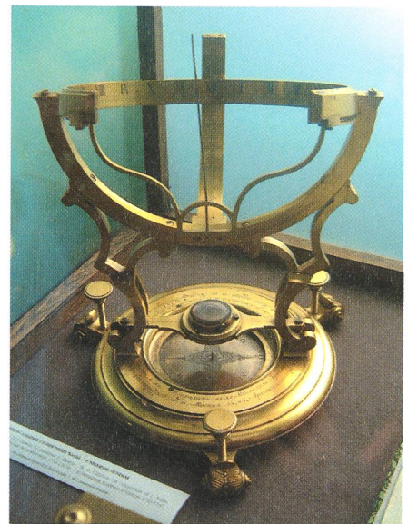
Fig. 31: Äquatoriale Universal-Sonnenuhr nach LEONHARD EULER. (Bild: A. VERDUN)
