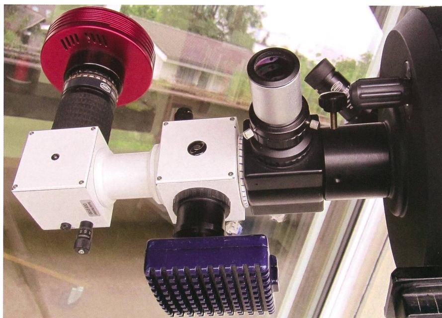
Abbildung 1: DADOS-Spektrograf mit vorgeschaltetem Klappspiegel, Spaltkamera DSI II und Aufnahmekamera Atik 314L+. (Bild: Richard Walker)
