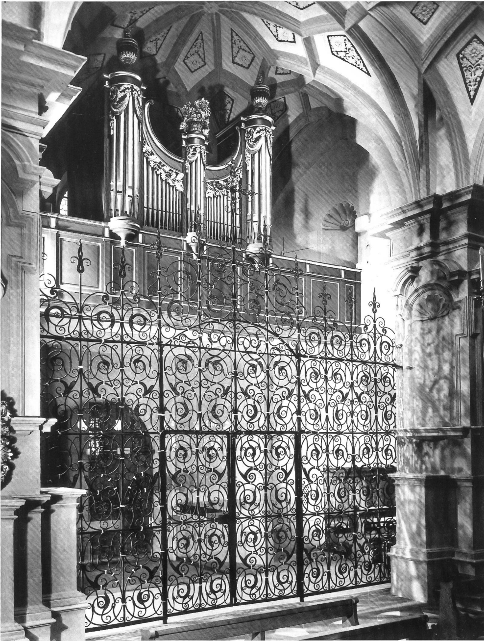
Fig. 63 Fribourg, église du monastère de la Visitation; construit par Aloys Mooser en 1825, cet instrument en balustrade, à un seul clavier, présente un buffet à 5 compartiments, richement décoré de grands vases d'amortissement et d'une corbeille de fruits couronnant la tourelle centrale. Seul instrument de Mooser avec console en fenêtre disposée latéralement (côté sud). Photo postérieure à la restauration effectuée par la Maison Kuhn en 1972. – Freiburg, Klosterkirche La Visitation; das Innere mit Blick vom Kuppelraum nach Westen auf die schmucke 5-teilige, einmanualige Brüstungsorgel von Aloys Mooser (1825) mit den typischen grossen klassischen Urnen auf den Aussentürmen und dem das Mitteltürmchen bekrönenden Fruchtkorb (vgl. Abb. 61); Zustand nach der Restaurierung durch Kuhn (1972). Einzige Moosergel mit seitlich (auf der Südseite) eingebautem Spieltisch.
