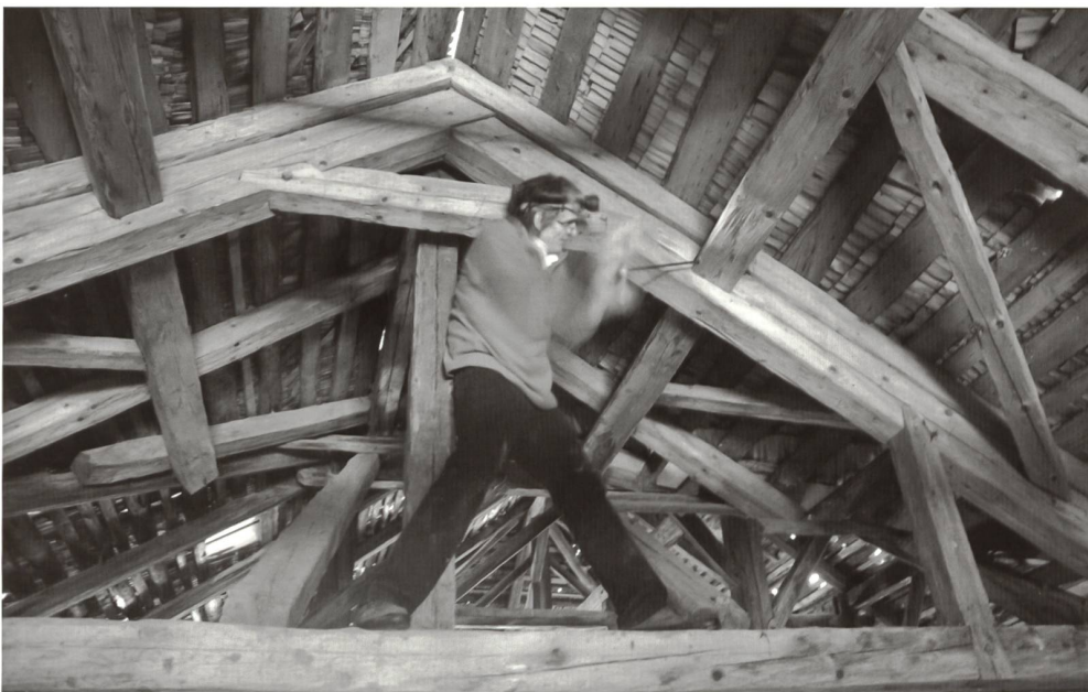
Fig. 14 Carottage à la tarière de Pressler sur la charpente de l'agrandissement de l'étable en vue de la datation dendrochronologique des bois.
