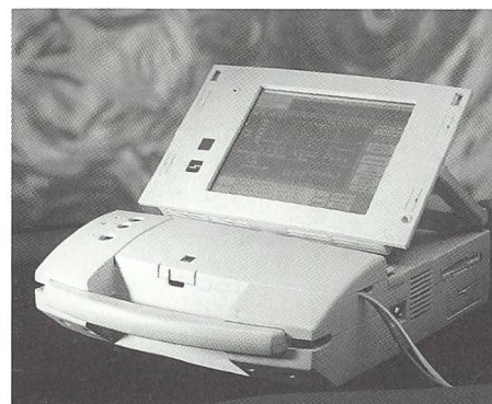
Abb. 8: Das Programmiergerät ist ein tragbarer PC mit Touch-Screen anstelle einer Tastatur. Das Kabel auf der rechten Seite des Geräts geht zum (nicht abgebildeten) Programmierkopf.
