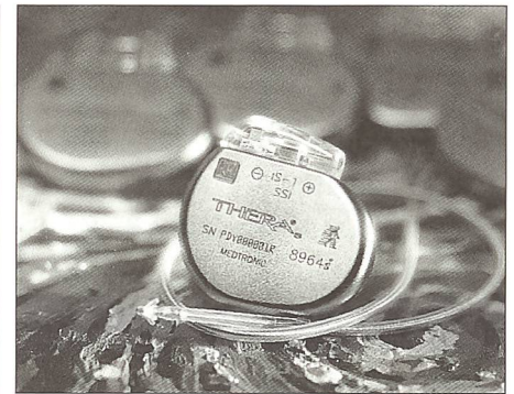
Abb. 2: Moderner Schrittmacher-Generator von der Grösse eines Fünffranken-Stücks. Vor dem Generator erkennt man eine Elektrode mit den Widerhaken an der Spitze.
