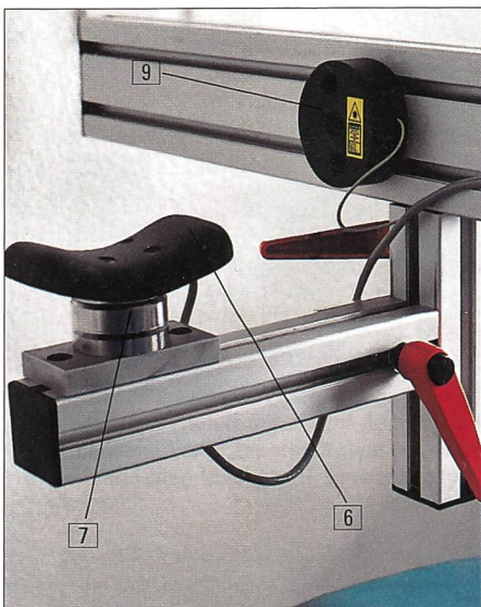
Abb. 8: Unter der Unterschenkelplatte [6] befindet sich der querkraftstabilisierte Kraftmesser [7]. Der Laser [9] wird auf den prominentesten Punkt des Malleolus lateralis eingestellt.
