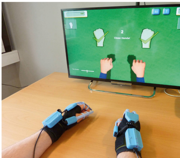
YouGrabber VR-Rehabilitationssystem für obere Extremitäten zeigt das Training von gegenseitigen Gesten. | Le système de rééducation de RV YouGrabber pour les extrémités supérieures montre l'entraînement de gestes réciproques.
