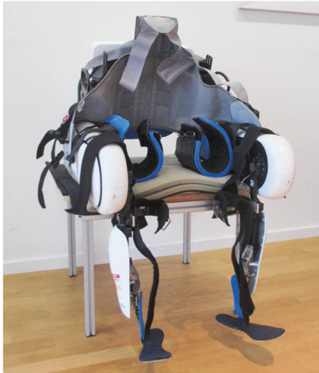
Das Exoskelett wiegt 35 Kilo, alltagstauglich ist es noch nicht. I L'exosquelette pèse 35kg, il n'est pas encore adapté à la vie de tous les jours.
