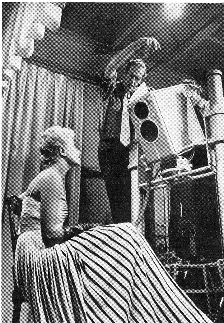
Ein Bild aus dem Fernsehstudio. Die beiden Operateure an der Arbeit mit ihrer Ikonoskop-Aufnahmekamera.
