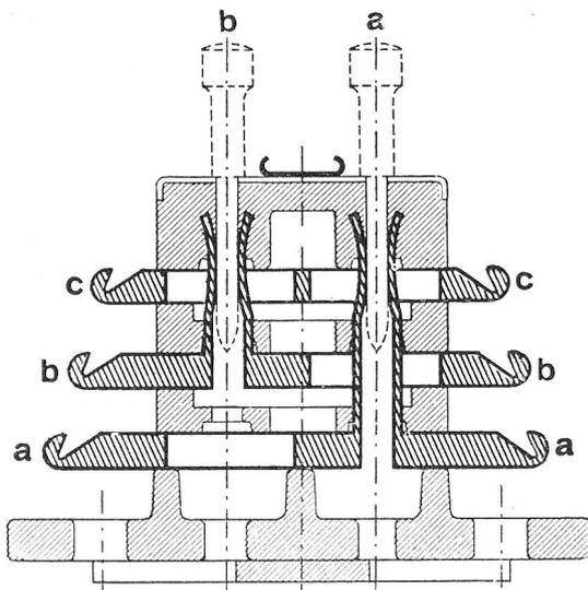
Solide Bauart und einfache Montage. Kleine Abmessungen, die gleichen wie Verteilerschienen 20teilig. Grosse Betriebssicherheit, geschützte Kontaktstellen, grosser Kontaktdruck, hoher Isolationswiderstand, kleiner Uebergangswiderstand an den Verbindungsstösseln. Prüfstecker mit Erdkontakt.
