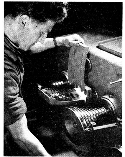
Das Verfeinern des Kupferdrahtes auf immer dünnere Drahtdurchmesser erfolgt in modernen Ziehmaschinen. Das Bild illustriert eine Feindrahtzieh-anlage, bei welcher der Kupferdraht durch kalibrierte Industriediamanten bis zu einem Drahtdurchmesser von 0,025 mm gezogen werden kann.
