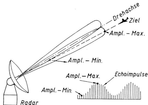
Fig. 6. Konische Abtastbewegung und amplitudenmodulierte Echoimpulse.
