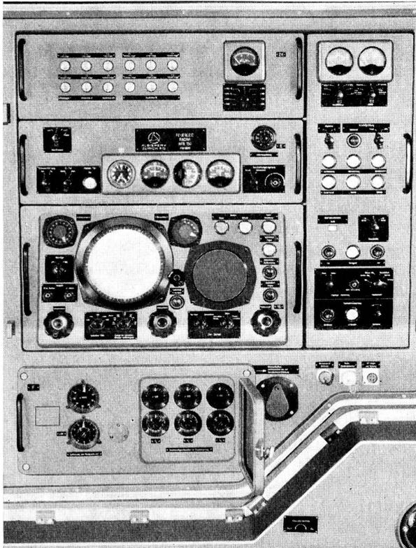
Fig. 13. Radaranzeige- und -bedienungsteil zu Feuerleitradar «Superfledermaus».
