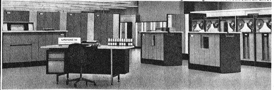
**UNIVAC 1107** Thin Film Memory Computer im ArithmaRechenzentrum, Zürich. Die Anlage umfasst: UNIVAC-1004-Subsystem, Grossraumspeicher-Subsystem FH 880, Magnetbandeinheiten Uniservo III C sowie verschiedene Lochkarten- und Lochstreifen-Aggregate
