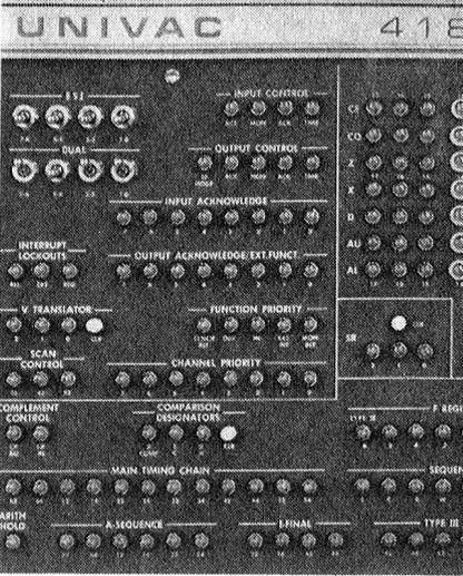
**UNIVAC III** bei der CIBA Aktiengesellschaft in Basel. Die Anlage verarbeitet 80stellige Karten und ist ausgerüstet mit 8 Magnetbandeinheiten Uniservo III
