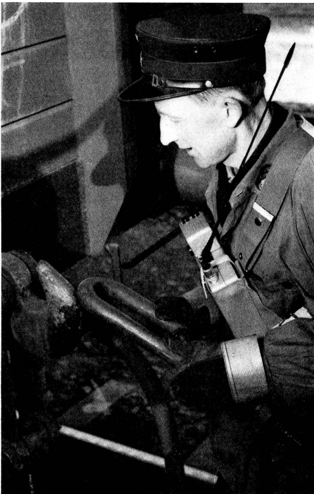
Fig. 5: Gerät SE 18 A im Einsatz im Rangierbetrieb. Dank dem Lautmonophon bleiben beim Empfang beide Hände frei, und beim Senden ist lediglich eine am Gerät angebrachte Taste zu drücken. Durch einen von der Gegenstation automatisch periodisch ausgesendeten Kontrollton hat der Mann Gewissheit, dass die Verbindung mit der Gegenstation vorhanden ist.
