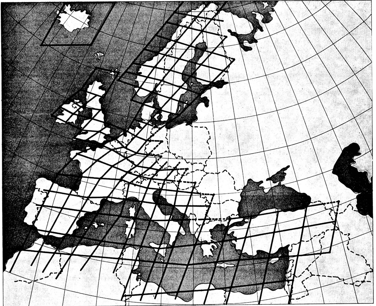
Fig. 3. Dichtenetz der UER-Länder für den Basisnetzplan nach Figur 3, auf Grund dessen die Frequenzplanung in diesem Bereich durchgeführt wurde. (Aus Techn. Mitt. PTT 12/1961.)
