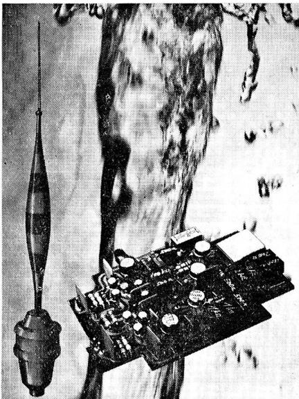
Im Laboratorium der ITT Bauelemente Gruppe Europa wurde ein Temperatursensor für den Gewässerschutz entwickelt, der die Wassertemperatur in einem Bereich von 0...140° C mit einer Genauigkeit von ± 0,1° C überwacht.
