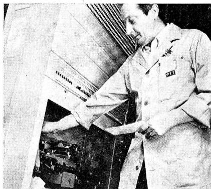
Der PTT-Fernmeldespezialist entnimmt dem Stanzer die Lochkarte
