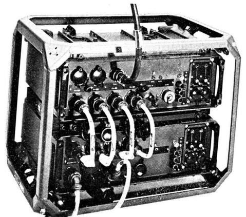
Modernes Mehrkanalgerät für die Uebertragung von 30 bis 120 Kanälen
