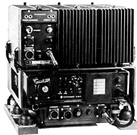
Das Feldfunkgerät SE 6861 in der Fahrzeughalterung und mit aufgesetztem Senderverstärker SV 6863. Die Sendeleistung beträgt maximal 150 Watt.
