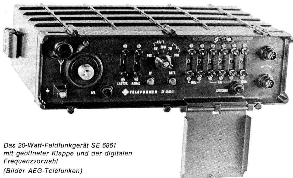
Das 20-Watt-Feldfunkgerät SE 6861 mit geöffneter Klappe und der digitalen Frequenzvorwahl (Bilder AEG-Telefunken)
