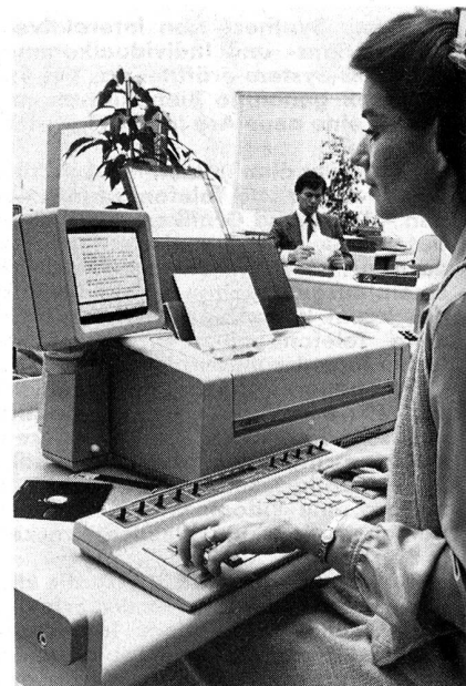
Sowohl als elektrische Schreibmaschine, elektronische Speicherschreibmaschine und vor allem als Übertragungsstation für die elektronische Textkommunikation können die neuen Textstationen von Siemens fungieren. Die für den von der Deutschen Bundespost geplanten Teletex-Dienst entwickelten Textstationen gibt es wahlweise mit Typen- oder Tintendruckwerk sowie mit oder ohne Bildschirmzusatz.
