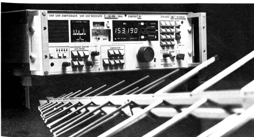
Zur Empfängerserie ESM 500, einer Typenreihe universell einsetzbarer Empfänger für den VHF-UHF-Bereich, gehören breitbandige Tischempfänger mit hohem Bedienungskomfort und – für den Einsatz in rechnergesteuerten Funkerfassungssystemen – preisgünstige Absetzempfänger mit speziell auf bestimmte Funkdienste zugeschnittenen Frequenzbereichen. Das Bild zeigt die Tischversion ESM 500 B mit der zugehörigen logarithmisch-periodischen Breitbandantenne HL 023.
