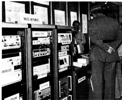
Im Anschluss an die Fachreferate konnten die Rapportteilnehmer verschiedene Einzelsysteme im Betrieb besichtigen. Unser Bild zeigt Teil eines automatischen Messsystemes für Funkgeräte. (Bild sp)
