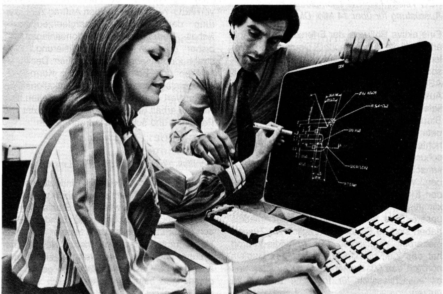
Grafisches Bildschirmsystem IBM 3250: Dieses Terminalsystem erlaubt die Entwicklung, Anzeige und Änderung von Diagrammen, Plänen und Zeichnungen am Bildschirm. Das System ist speziell für komplexe grafische Darstellungen geeignet und auf die intensive Interaktion zwischen dem Benutzer und dem IBM-System ausgelegt. Der Einsatzbereich des Systems 3250 dürfte daher vor allem in der Industrie – computerunterstützte Konstruktion und Fertigung – sowie in der öffentlichen Verwaltung liegen.
