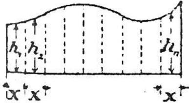
Durch Zerlegung in parallele Streifen von gleicher Breite  $x$  und mittl. Höhen  $h_1, h_2, \dots, h_n$ .
