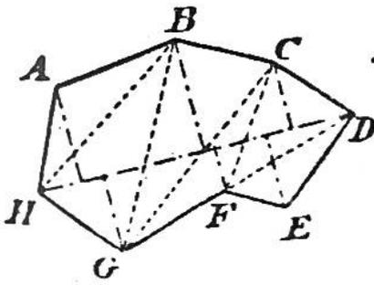
Die Fläche kann berechnet werden durch Zerlegung des Vielecks in Dreiecke mittels Diagonalen u. Summierung der ermittelten Dreiecksflächen, oder auch durch Einteilung in Trapeze u. Dreiecke vermittels einer passend gewählten Abscisse und rechtwinklig auf diese errichteten Koordinaten der Eckpunkte, Summierung des ermittelten Inhalts dieser Trapeze u. Dreiecke.
