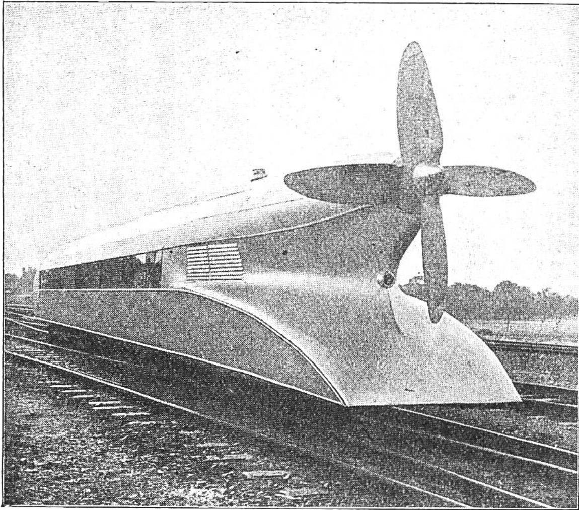
Der Propeller-Triebwagen, von hinten gesehen. Höchstgeschwindigkeit: 230 km die Stunde.
