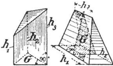
Flächeninhalt des senkrechten Querschnittes =  $G$ ,Länge der Kanten =  $h, h_2, h_3, \dots, h_n$ ,Inhalt  $K = G \cdot \frac{h_1 + h_2 + h_3 + \dots + h_n}{n}$ .
