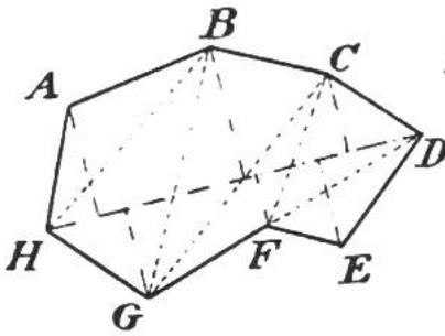
Die Fläche kann berechnet werden durch Zerlegung des Vielecks in Dreiecke mittels Diagonalen u. Summierung der ermittelten Dreiecksflächen, oder auch durch Einteilung in Trapeze u. Dreiecke vermittels einer passend gewählten Abszisse und rechtwinklig auf diese errichteten Koordinaten der Eckpunkte, Summierung des ermittelten Inhalts dieser Trapeze u. Dreiecke.
