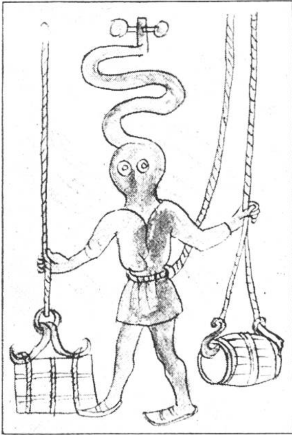
Taucheranzug mit Luftschlauch, der die Atmung unter Wasser ermöglicht, nach der Zeichnung eines unbekanntes Erfinders um 1430.
