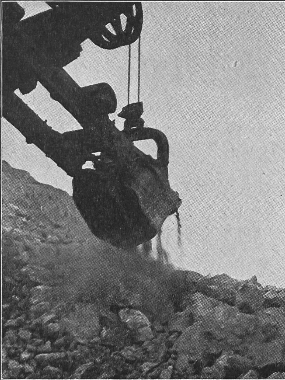
Ein Schürfkran packt die losgesprengten Erzstücke und befördert sie in Eisenbahnwagen, die mit der wertvollen Last hinunter zur Schiffsstation fahren.
