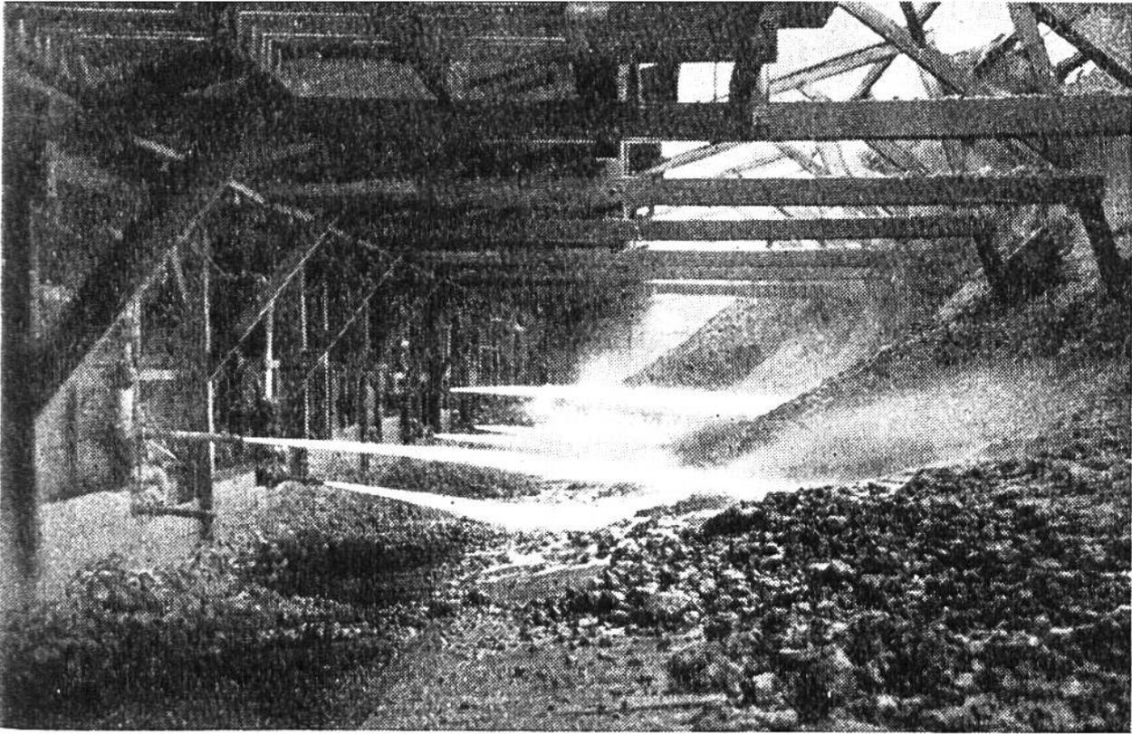
B e r n s t e i n w ä s c h e r e i . Die im Tagebau abgetragene Erde wird mit Hilfe von starken Wasserstrahlen aufgelöst und die darin enthaltenen Bernsteinstücke herausgeschwemmt.
