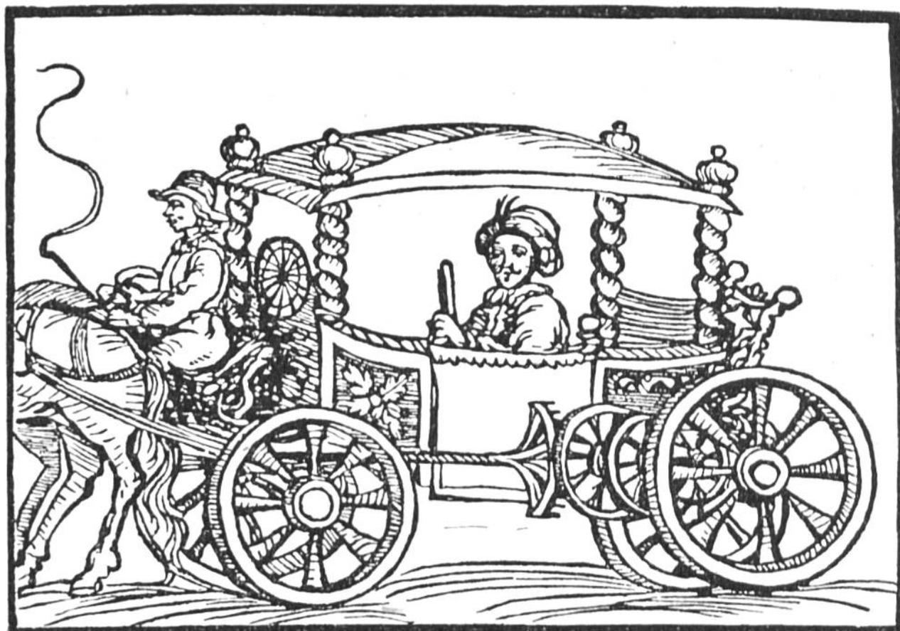
Wegmesswagen aus dem 17. Jahrhundert. Zwischen den Wagenrädern sieht man die Zahnräder-Übersetzung, die mit dem Zifferblatt, hinter dem Kutschersitz, in Verbindung steht.
