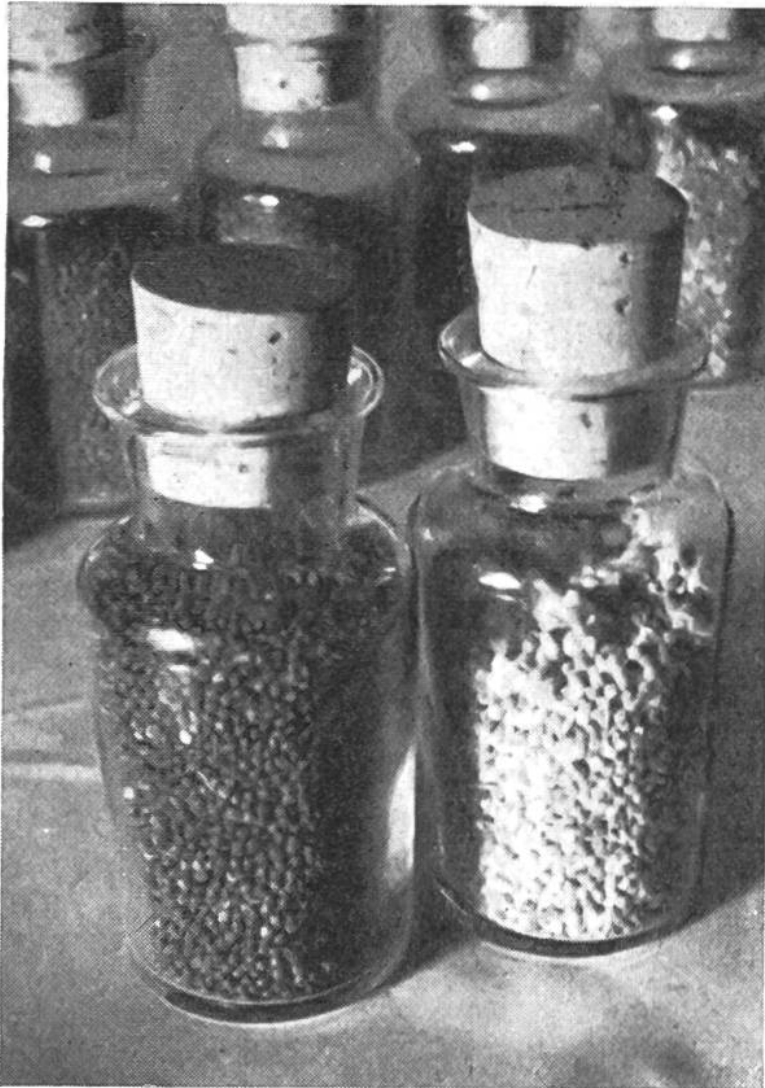
Die dunkle Rapssaat links entspricht den Qualitätsanforderungen; die Probe rechts mit den hellen Samen ist vollständig verschimmelt.
