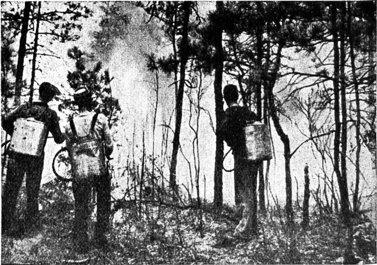
Löscheimer mit Pumpvorrichtung, wie sie bei uns zum Bespritzen der Reben benutzt werden.
