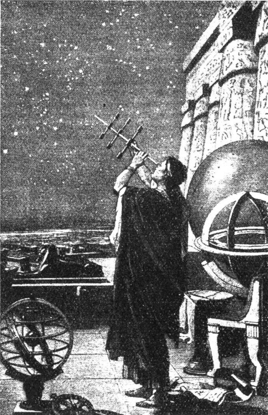
Ein Alexandriner misst die Höhe eines Sterns mit Hilfe des Jakobsstabes. Dieses Winkelmess-Instrument diente früher den Seefahrern zur Bestimmung der Zeit und geographischen Breite.
