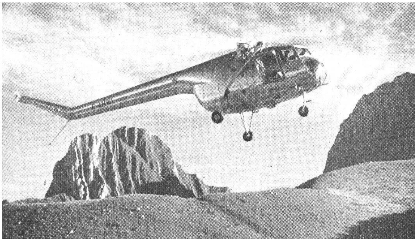
Ein 5plätziger BRISTOL 171 Helicopter bei einer Rettungsübung im Gantrischgebiet. Die Maschine erreicht mit einem Motor von 550 PS eine Höchstgeschwindigkeit von 205 km/h.
