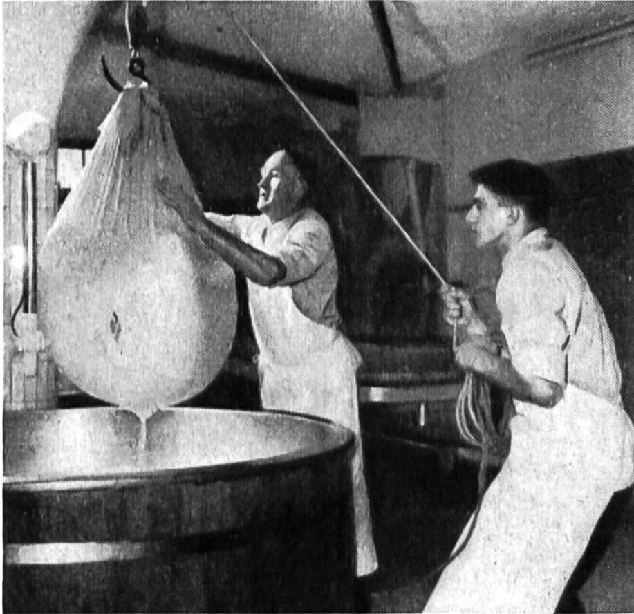
Ein wichtiger Augenblick – die über 100 kg wiegende Käsemasse wird in einem Tuch aus dem Kessi auf den Presstisch gehoben.
